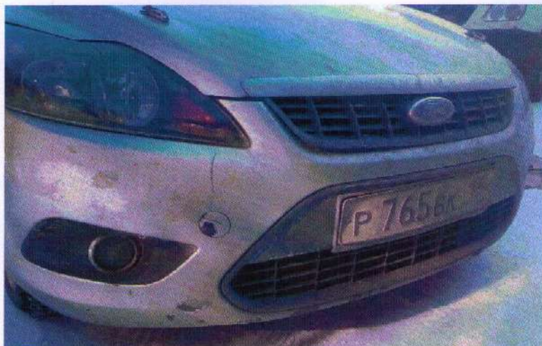
Трещины и сколы на переднем бампере
